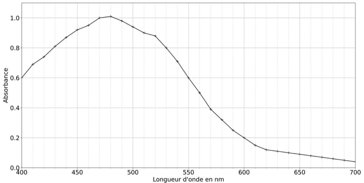
Figure 4. Spectre d'absorption de la molécule DOPAchrome.
