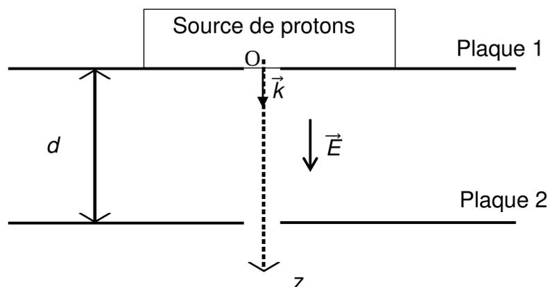
Figure 1. Schéma d'un accélérateur constitué du condensateur plan.
