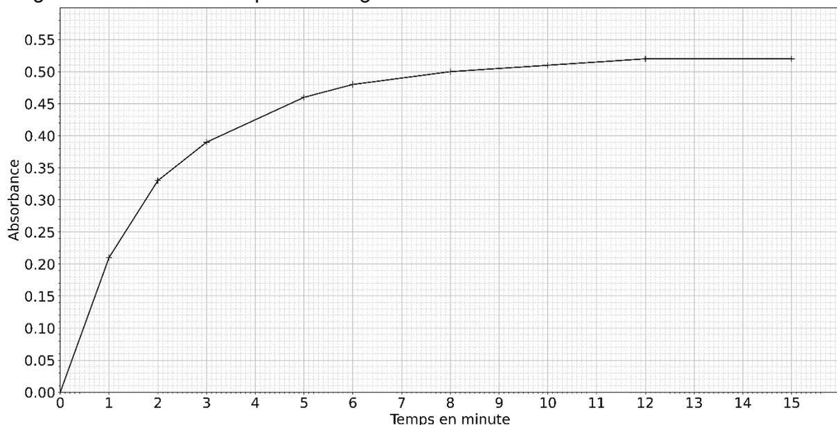
Figure 5. Suivi spectrophotométrique de la réaction de formation de DOPAchrome.
